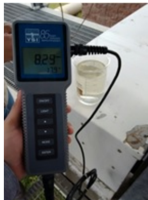
Figure 3. Equipo DO meter.
