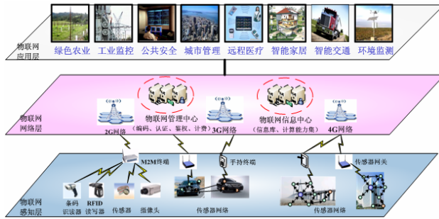
Figure 1. architecture of IOT 图 1. 物联网的三层参考体系架构图
